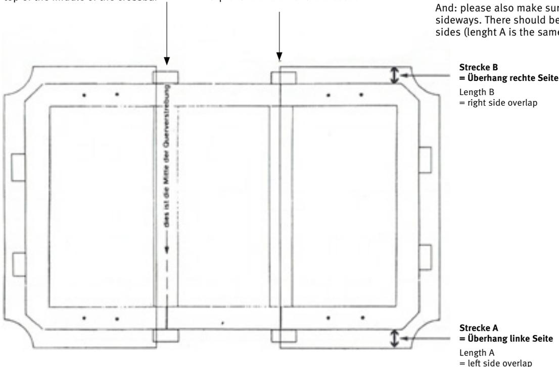
1. Nun befestigst Du das erste Drittel des Schieferspielfeldes mit den Schrauben, damit es sich nicht mehr verschieben kann (ziehe die Schrauben nur leicht an – die Feinjustierung erfolgt dann, wenn alle Schieferplatten aufliegen)
